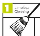
Limpie la superficie y las boquillas a rellenar usando una escoba, cepillo o aspiradora, retirando completamente el polvo y restos de adhesivo seco.
