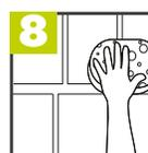
Si el mortero epoxi entra en contacto con la superficie de la loseta, retírelo con una esponja húmeda antes de que se seque.
