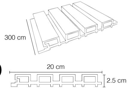
Lambrín de WPC con revestimiento de polímeros de ingeniería, resistente al agua, decoloración y condiciones climáticas extremas. Con garantía de hasta 20 años. Este revestimiento ofrece una combinación perfecta de belleza y durabilidad, añadiendo un toque elegante y moderno a tus espacios exteriores residenciales y comerciales.
