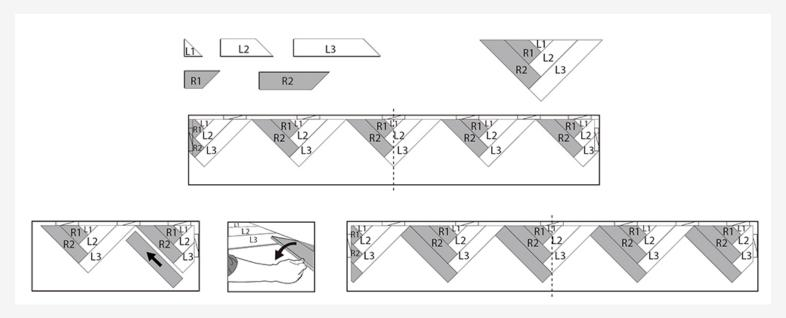
– Cuando llegue a ambos lados de las paredes, mida la distancia entre la pared y el set inicial más cercano. Arme un nuevo set, marque la distancia medida en él, corte los tablones (para esto puede desarmar el set) e instale los tablones en el hueco restante.
