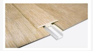
Para superficies que excedan de 400 m2, longitudes superiores a 20 m o para transición de Click&Floor a otro material, se recomienda la utilización de perfiles en T respetando la junta de dilatación (misma que la perimetral).
