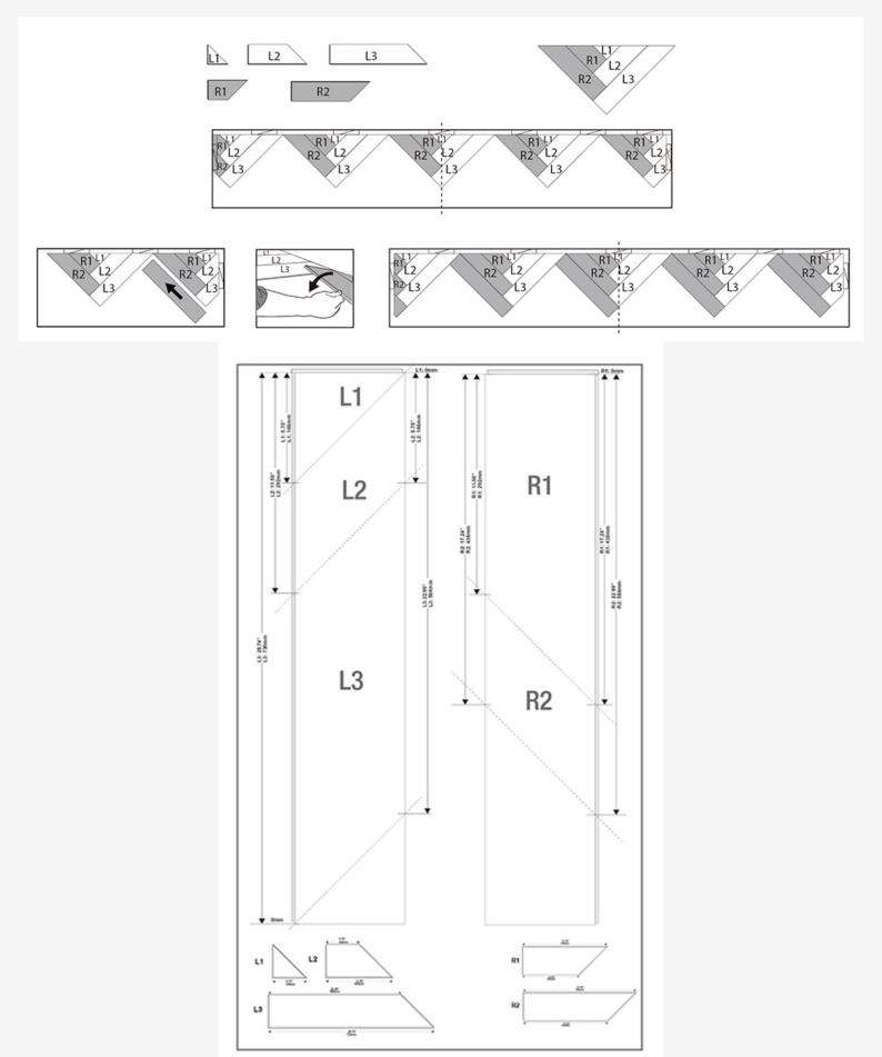
Cuando llegue a ambos lados de las paredes, mida la distancia entre la pared y el set inicial más cercano. Arme un nuevo set, marque la distancia medida en él, corte los tablones (para esto puede desarmar el set) e instale los tablones en el hueco restante.
