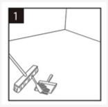
El subsuelo debe estar nivelado, seco y limpio. Las grapas de moquetas o residuos de pegamento deben ser eliminados y el piso debe estar limpio para asegurar una instalación adecuada.
