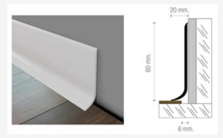
Flexi es un rodapié fabricado en PVC semi flexible. combina las excelentes propiedades de resistencia del PVC rígido con un el grado de flexibilidad idóneo para su adaptación a paredes irregulares o ligeramente curvas. Su remate en escocia facilita la limpieza, evitando la acumulación de gérmenes. Muy adecuado para cubrir las juntas perimetrales. Fácil de instalar, se coloca pegado a la pared y descansando sobre C&F sin aprisionarlo. Es perfecto para reformas y obra nueva.
